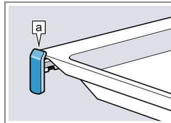
**Nota:** Los rieles de extracción encajan en su lugar cuando están completamente extraídos. Volver a introducir los rieles de extracción en el compartimento de cocción ejerciendo un poco de presión.
