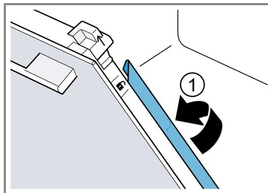
4. Introducir el cristal interior abajo en la sujeción ① y colocarlo en la parte superior.
