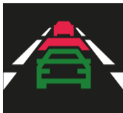
1. sledování nebezpečné blízkosti objektu
