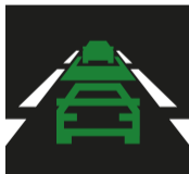
3. предупреждение о начале движения объекта впереди
