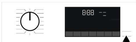
Si el nivel de agua en la máquina es insuficiente al presionar el botón Inicio/Pausa, el bloqueo de la puerta no se puede desactivar y el ícono de bloqueo de la puerta en la pantalla seguirá apareciendo.
