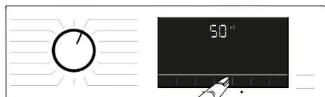
1. Pulse la tecla Dosificación automática. Cuando el detergente líquido está activado y el suavizante está desactivado, se activa la pantalla de ajuste de detergente líquido. Cuando el detergente líquido está apagado y el suavizante está encendido, se activa la pantalla de ajuste del detergente líquido. El LED de la pantalla de ajuste activo se enciende.
