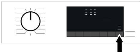
Cuando el Mando a Distancia está activado, usted sólo puede manejar la máquina, apagarla y seguir el estado a través de su lavadora. Y todas las funciones, excepto el bloqueo para niños, se pueden gestionar a través de la aplicación.
