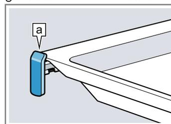
**Nota:** Los rieles de extracción encajan en su lugar cuando están completamente extraídos. Volver a introducir los rieles de extracción en el compartimento de cocción ejerciendo un poco de presión.
