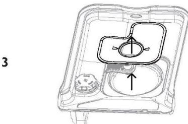
Retire el filtro de drenaje y la placa del filtro. Utilice una esponja para eliminar cualquier resto de agua de debajo antes de reemplazar.
