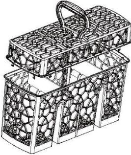
Coloque los cubiertos con los mangos hacia abajo para conseguir mejores resultados de lavado. Si los objetos largos obstruyen el movimiento de los brazos aspersores, busque una posición horizontal en el cesto superior.
