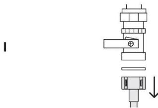
Cierre el suministro de agua. Desconecte las mangueras de desagüe del tubo de desagüe del fregadero y la tubería de entrada de agua de la válvula de agua.
