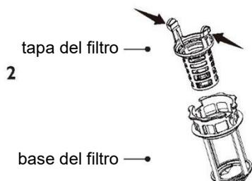
Separe la tapa del filtro de la base presionando los botones de liberación y levantando.
