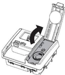
Si se ilumina el indicador del abrillantador, llene el dispensador correspondiente. Consulte la sección 'Abrillantador' para obtener orientación adicional.
