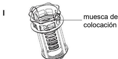
Alinee la tapa del filtro con la muesca de la base del filtro. Asegúrese de que la estructura de la hebilla está en su sitio.
