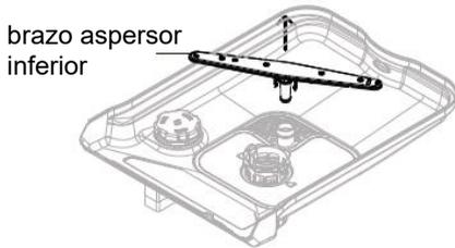
Para retirar el brazo aspersor inferior, sáquelo de la base del lavavajillas. Enjuague bien el brazo aspersor con agua corriente y vuelva a colocarlo. Asegúrese de que el brazo gira libremente cuando vuelva a montarlo.
