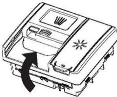
Retire el exceso de detergente y cierre la tapa. Hará clic cuando esté bien colocada. Si es necesario, añada detergente adicional al compartimento del prelavado situado encima del dispensador.
