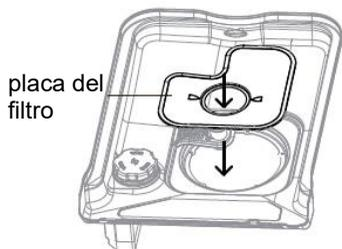
Coloque la placa del filtro debajo de los clips de ubicación en la parte trasera del desagüe y empújela con firmeza hasta que quede en su sitio. Asegúrese de que la placa del filtro está a ras de la base del lavavajillas.
