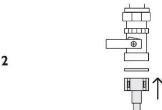
Drene el agua de las mangueras, la tubería de entrada y la válvula de agua, utilizando un cubo o una cacerola para recoger el agua. Vuelva a conectar la tubería de entrada de agua a la válvula de agua y las mangueras al tubo de desagüe del fregadero.
