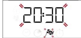
Utilice + o - para ajustar el tiempo deseado de finalización de cocción y pulse para confirmar. Active la función girando el selector del termostato hasta la temperatura deseada: la función permanecerá en pausa hasta que se inicie automáticamente en el tiempo calculado en función de la hora de finalización de la cocción seleccionada.
