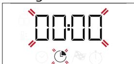
+ oder - zum Einstellen der gewünschten Garzeit verwenden, anschließend
