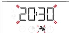
Utilize + ou - para definir o tempo de fim da cozedura pretendido e, em seguida, prima para confirmar. Ative a função rodando o botão do termóstato para a temperatura requerida: a função irá permanecer em pausa até se iniciar automaticamente no tempo calculado com base no tempo de fim de cozedura selecionado.
