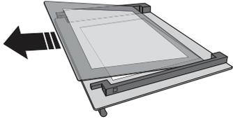
**3.** Bringen Sie die mittlere Scheibe (mit „R“ gekennzeichnet) an, bevor Sie die Innenscheibe wieder einsetzen: Um das Glasscheiben richtig einzusetzen, sicherstellen, dass das Zeichen „R“ in der linken Ecke sichtbar ist. Zuerst die lange Seite des Glas, die mit einem „R“ gekennzeichnet ist in die Halterungen einsetzen, dann in die Position absenken. Wiederholen Sie diesen Vorgang bei beiden Glasscheiben.
