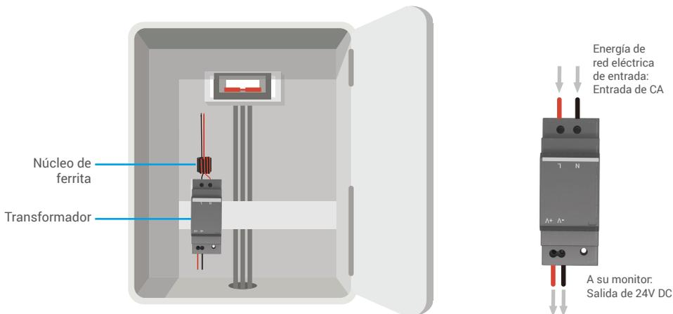
**i** Para evitar los riesgos de interferencia electromagnética en otros dispositivos, los cables de alimentación desde la caja de fusibles deben pasar a través del núcleo de ferrita y enrollarse alrededor de él cuatro veces antes de conectarse a la entrada de CA del transformador.
