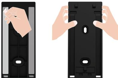
3. Adjunte el teclado al soporte de pared, como se muestra en la figura de abajo..
