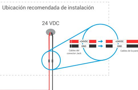
**⚠ Advertencia:** Asegúrese de que todos los cables estén bien conectados antes de conectar el otro extremo del cable conector de enchufe de suministro de energía de DC 24V en el puerto de alimentación del monitor.
