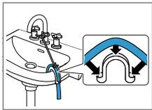
Fijar y asegurar la manguera de desagüe con un racor en codo. → "Accesorios", *Página 27*
