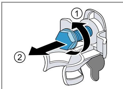
3. Retirar el cable de conexión de la sujeción.
