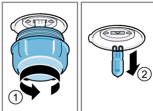
4. Colocar y presionar firmemente en el enchufe la lámpara halógena. Atención a la posición de los pines.
