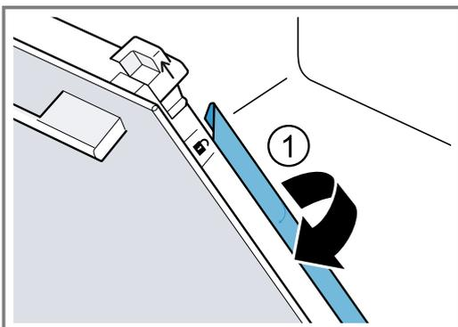
8. Extraer el primer y segundo cristal intermedio tirando de ellos hacia arriba en posición inclinada y depositarlos con cuidado sobre una superficie plana.
