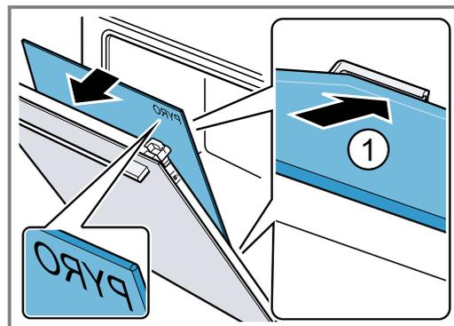
5. Apretar la parte superior del cristal interior ①. Presionar hacia abajo las tapas deslizantes [a] en la dirección de la flecha.
