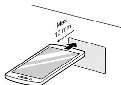
**3** Pulse y mantenga presionado el botón **Inicio Diferido** durante 3 segundos o más mientras sostiene el micrófono del teléfono inteligente junto al logo hasta que la transferencia de datos haya finalizado.
