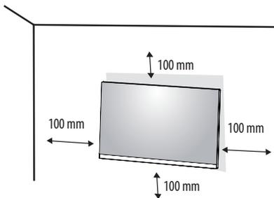
Si instala el monitor en una pared, fije un soporte de montaje en pared (opcional) en la parte trasera del monitor. Asegúrese de que el soporte de montaje en pared esté bien fijado al monitor y a la pared.
