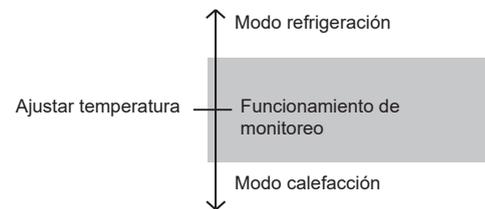
Al seleccionar el modo Auto (Automático) automático por primera vez, el ventilador funcionará a velocidad muy baja durante unos minutos, mientras la unidad interior determinará las condiciones de la habitación y seleccionará el modo de funcionamiento adecuado.
