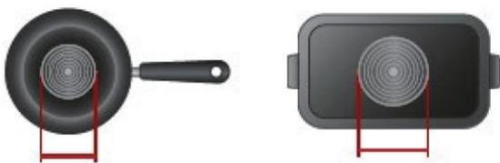
5. Si la parte ferromagnética cubre parcialmente la base de la sartén, sólo se calentará la zona ferromagnética; el resto de la base no se puede calentar a una temperatura suficiente para cocinar.
