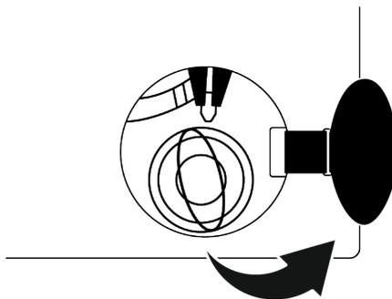
3. Tire hacia abajo de la manilla de emergencia de la puerta de carga con una herramienta y suéltela. A continuación, abra la puerta de carga.
