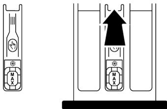
1. Presione la parte marcada del sifón dentro del compartimento del suavizante y luego tire del cajón hacia usted para sacarlo.
