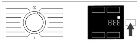
Si el nivel de agua en la máquina no es el adecuado al pulsar el botón de Inicio/Pausa, el bloqueo de la puerta no se puede desactivar y el icono de bloqueo de la puerta en la pantalla permanece encendido.
