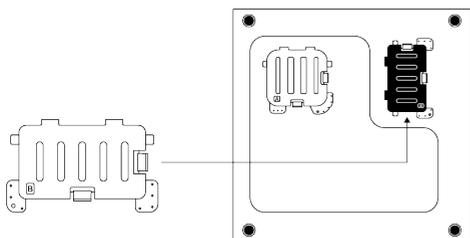
Apoye las lengüetas de la cubierta B contra el panel inferior. Complete el montaje girando la tapa.
