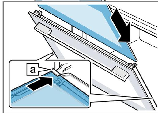
7. Presionar el cristal interior por arriba hasta que quede en la sujeción izquierda y derecha **a**.
