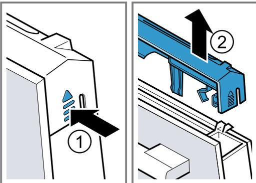
6. Extraer el cristal interior y depositarlo con cuidado sobre una superficie plana.
