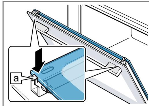
8. Colocar la cubierta de la puerta **1** y presionar hasta que se oiga que ha encajado.
