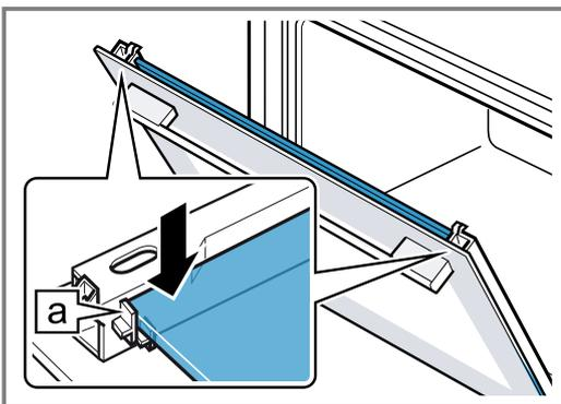
5. Abrir la puerta del aparato y enganchar la junta de la puerta.
