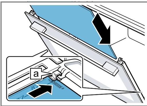
4. Presionar el cristal intermedio por arriba hasta que quede en la sujeción izquierda y derecha **a**.
