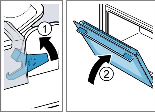
4. Presionar la cubierta de la puerta a izquierda y derecha desde fuera ① hasta que se desencaje.
