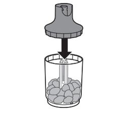
**3** Setzen Sie die Antriebseinheit für den XL Zerkleinerer auf den Zerkleinerer-Behälter.
