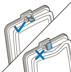
Hinweis: Wenn die Gummikante des Motorschutzfilters aus dem Rahmen ragt, dann wurde der Motorschutzfilter nicht korrekt eingelegt, und der Filter kann nicht wieder in den Staubbehälter eingesetzt werden. Lösen Sie den Motorschutzfilter aus dem Rahmen und wiederholen Sie den in Schritt 7 beschriebenen Vorgang.
