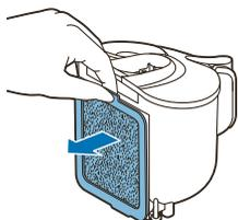
**2** Entfernen Sie den Staubbehälter aus dem Gerät und ziehen Sie die Filtereinheit aus dem Staubbehälter.
