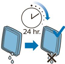
Hinweis: Trocknen Sie den Motorschutzfilter und den Rahmen nicht auf einem Heizkörper, im Wäschetrockner oder an einem Ort mit direkter Sonneneinstrahlung.
