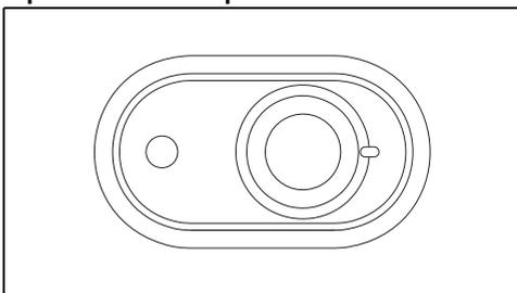
Gire el selector termostato de la posición ● (mínimo) a **5** (máximo) dependiendo de la temperatura deseada.
