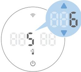
Drücken Sie in der Funktion **Lüfter/Zirkulation** die  $\Delta/\nabla$ -Taste, um die Lüftergeschwindigkeit zwischen 1 und 10 einzustellen.
