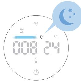
**Ruhemodus (☾):** Das Gerät wird mit sehr niedriger Geschwindigkeit betrieben. Nach 3 Sekunden schaltet sich die Bildschirmbeleuchtung aus.
