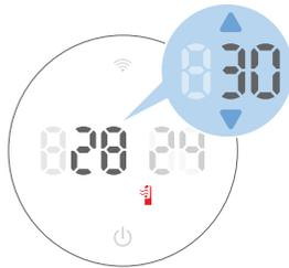
Drücken Sie in der **Heizfunktion** die  $\Delta/\nabla$ -Taste, um die Temperatur zwischen 1 °C und 37 °C einzustellen.
