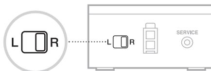
**NOTA:** Asegúrese de que siempre haya un receptor inalámbrico en la posición **L** (izquierda) y el otro en la posición **R** (derecha).
