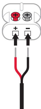
**NOTA:** Asegúrese de insertar solamente las partes peladas y estañadas de cada alambre expuesto para evitar restringir el aislamiento del cable.
