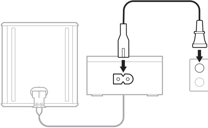
2. Enchufe el otro extremo del cable de corriente a una salida de CA (red eléctrica).
