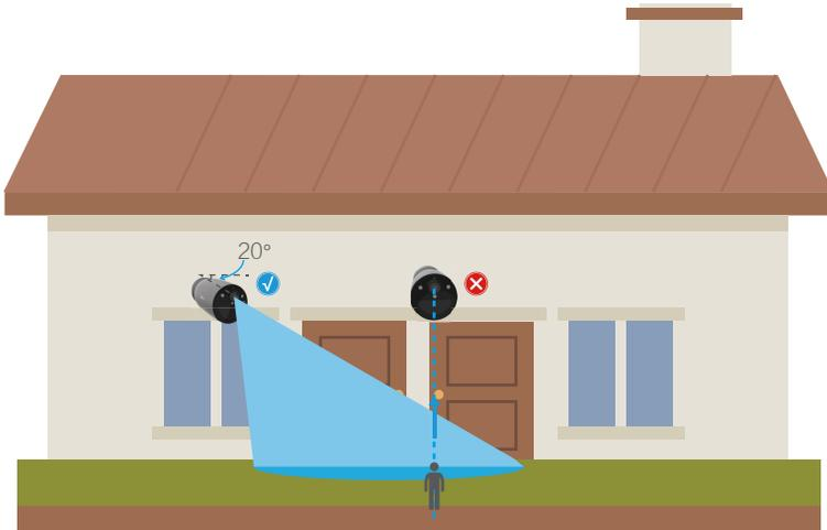
**i** Limitada por la tecnología de detección PIR, puede que la cámara no detecte el movimiento cuando la temperatura ambiente sea similar a la temperatura corporal o si alguien se acerca al sensor PIR en línea recta.
