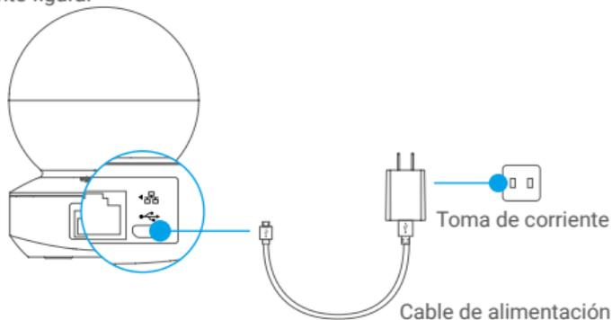
**i** El led parpadeando rápidamente de color azul indica que la cámara está encendida y preparada para la configuración de la red wifi.
