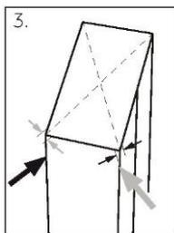
1. Puede comprobarse la estabilidad golpeando alternativamente las diagonales. El ligero bamboleo debe ser el mismo en ambas direcciones. De lo contrario, el marco puede deformarse y resultar en fugas en las juntas de la puerta. Una ligerísima inclinación hacia atrás facilita el cierre de las puertas.
