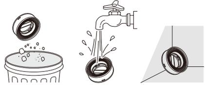
5. Alinee el filtro de escape en la posición abierta y gírelo en el sentido de las agujas del reloj hasta la posición de bloqueo **4** para montarlo en el cuerpo del aparato.
