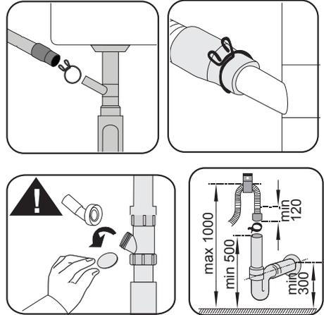
**i** La tubería de desagüe debe conectarse al sistema de aguas residuales y no debe conectarse a aguas superficiales.
