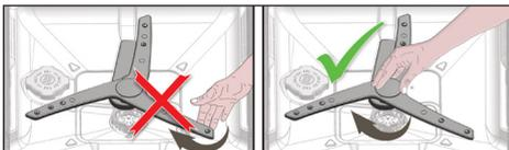
**i** No intente girar el impulsor sujetando sus extremos. Intentar girar las secciones finales puede causar que el sistema de engranajes dentro del impulsor se rompa.
