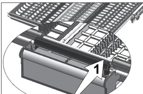
En modelos con la característica de movimiento parcial, presionando la barra (1) en el asa permite que la bandeja central de la cesta acceda a la posición inferior y el sistema se desbloquee. Así se pueden utilizarse las bandejas laterales derechas e izquierdas como partes móviles. El espacio libre habilitado por las bandejas laterales permite la carga de piezas largas en la cesta superior.
