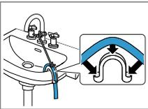
Fijar y asegurar la manguera de desagüe con un racor en codo. → "Accesorios", *Página 31*
