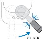
La fonction de démarrage instantané vous permet d'allumer votre machine et de vous préparer facilement un délicieux café. Il n'y a pas de bouton marche/arrêt. Il suffit d'appuyer sur le bouton du café à préparer. Puis, tournez le manche du porte-filtre vers la droite pour lancer le processus de mouture et de préparation.
