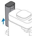
2 Retirez le réservoir d'eau de la machine.
