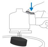
Grâce à ce bouton d'éjection, il est très facile de retirer la rondelle de café après chaque infusion. Retirer la rondelle de café en tenant le porte-filtre à l'envers et en appuyant sur le bouton d'éjection.
