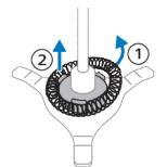
**2** Retirer le couvercle et retirer le support de fouet du mousseur à lait.
