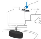
Met deze uitwerpknop kunt u eenvoudig het koffiedik na elke koffiebereiding verwijderen. Verwijder het koffiedik door het portafilter ondersteboven te houden en op de uitwerpknop te drukken.
