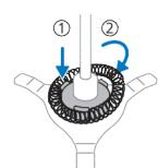
**4** Placez le fouet sur son support. Placez le support du fouet et le fouet dans le mousseur à lait.
