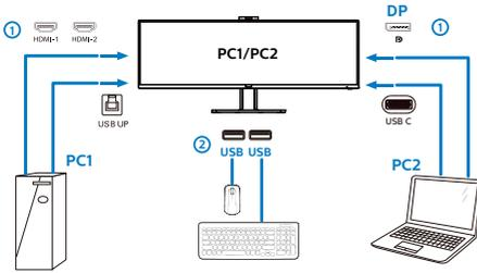
3. Ingrese al menú OSD. Vaya a la capa KVM y seleccione “Auto”, “USB C” o “USB up” para cambiar el control de los periféricos de un dispositivo a otro. Simplemente repita este paso para cambiar el sistema de control usando un conjunto de periféricos.
