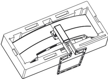
2. Afloje los tornillos de montaje y, a continuación, extraiga el soporte del monitor.
