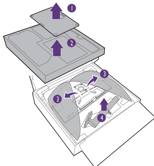
Acople el soporte de la base del monitor según se muestra.
