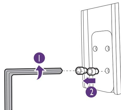
4. Fije ligeramente los tornillos a los otros dos de orificios de tornillo.
