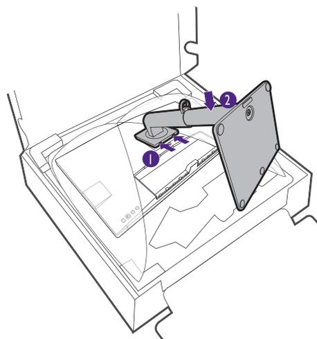
Levante el monitor con cuidado, gírelo y colóquelo verticalmente sobre su soporte en una superficie plana y homogénea.
