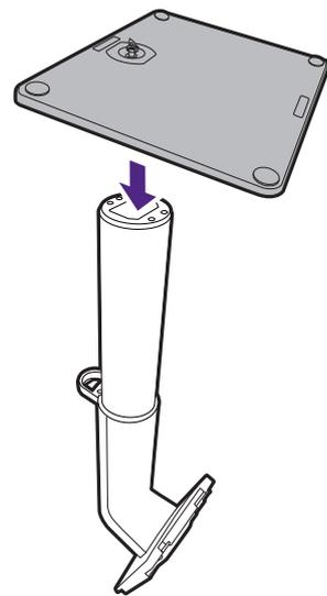
Levante la tapa de los tornillos y apriete los tornillos según se ilustra. A continuación, vuelva a colocar la tapa.
