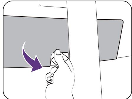
Retire la cubierta de gestión de cable. Desenchufe todos los cables con cuidado.
