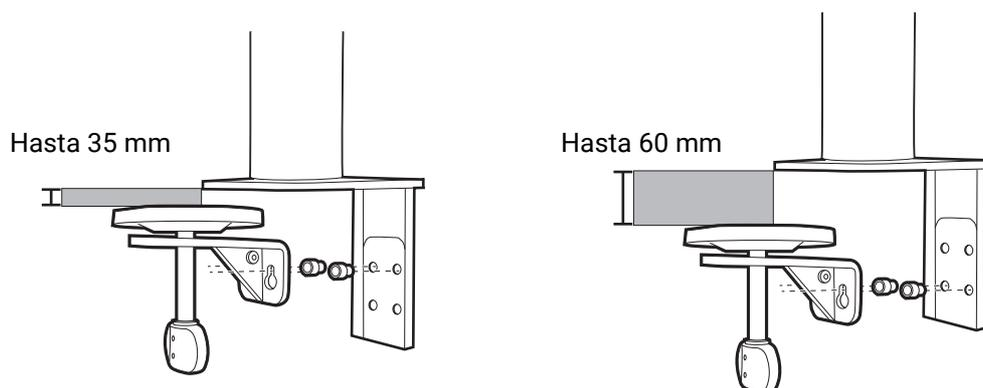
1. Utilice la llave hexagonal incluida para aflojar ligeramente los tornillos que fijan la abrazadera en C.
