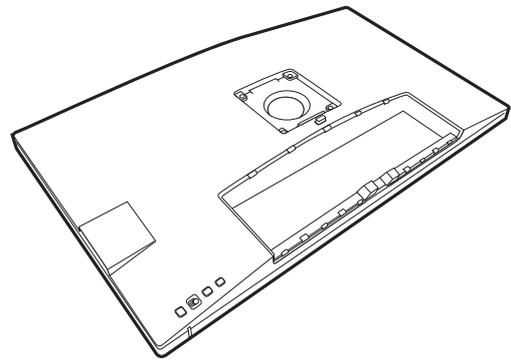
Use un destornillador de estrella para quitar los tornillos que sujetan la tapa posterior al monitor. Se recomienda utilizar un destornillador de cabeza magnética para evitar que se pierdan los tornillos.
