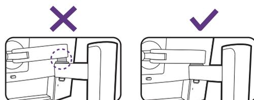
Levante la tapa de los tornillos y apriete los tornillos según se ilustra. A continuación, vuelva a colocar la tapa.
