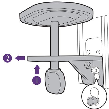
3. Suelte los tornillos por completo para poder apretarlos a los otros dos orificios de tornillo.
