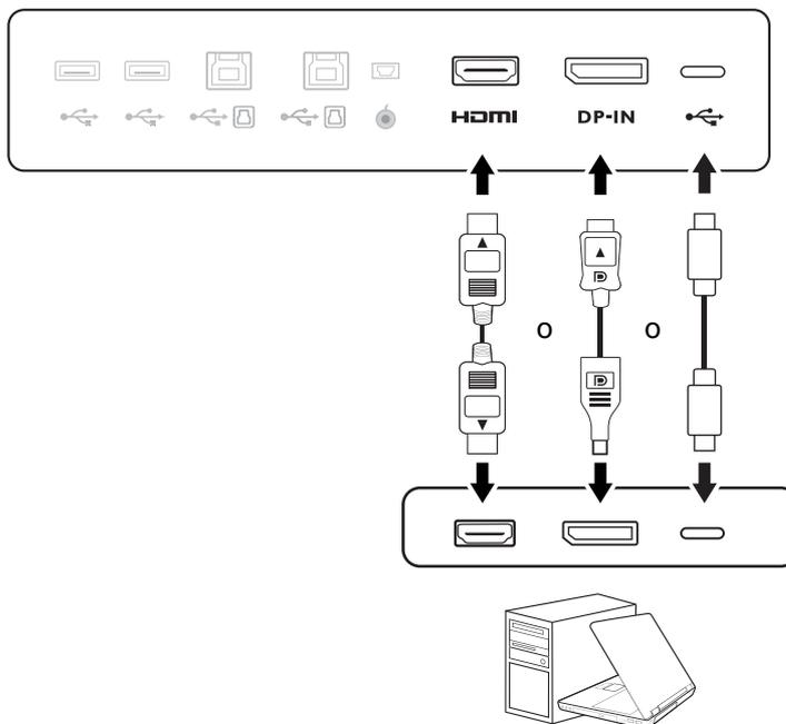
2. Conecte el otro extremo del cable de vídeo a un puerto apropiado de una fuente de salida digital (p. ej.: un ordenador).
