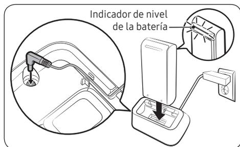
Cargue la batería adicional en el soporte de la batería.
