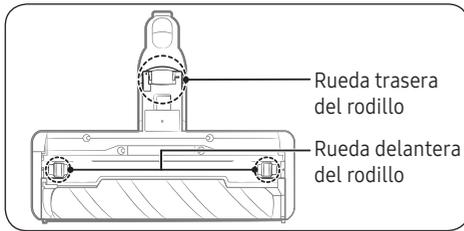
Utilice un destornillador pequeño para desmontar las ruedas delanteras y traseras.
