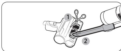
Corte el pelo o pelaje enmarañado con tijeras y, a continuación, utilice un aspirador para aspirar los restos.
