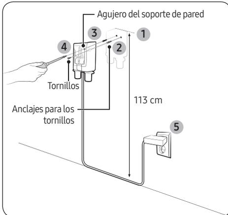
1. La instalación del soporte de pared debe realizarse de modo que la parte superior del soporte de pared quede a 113 cm del suelo.
