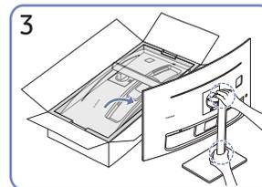
Levante el monitor, tal como se muestra en la ilustración.
