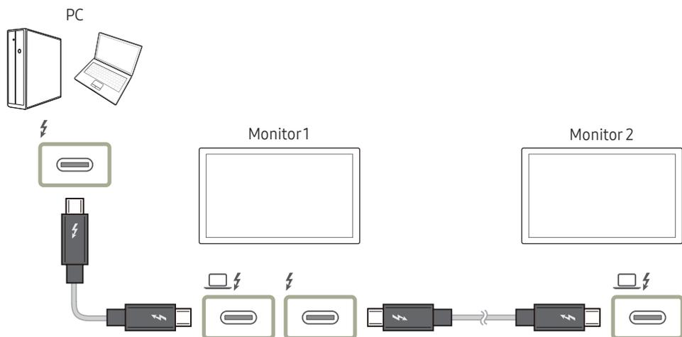
La compatibilidad con pantalla dual (conexión en cadena) depende del PC y del cable Thunderbolt™ 3 / 4 conectado. El puerto Thunderbolt™ 4 de su PC debe admitir una salida dual 4K a 60 Hz, y es necesario adquirir por separado el cable específico Thunderbolt™ 3 / 4 de 40 Gbps. Para conocer las especificaciones detalladas del cable Thunderbolt™ 3 / 4, visite el sitio web oficial de Thunderbolt.
