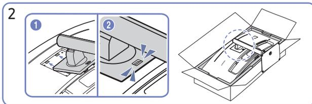
Presione el soporte montado dentro del cuerpo principal en la dirección de las flechas, como se muestra en la ilustración.
