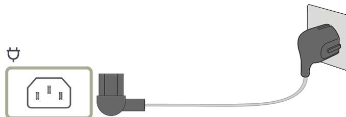
Para utilizar el producto, conecte el cable de alimentación a una toma de corriente y al puerto
