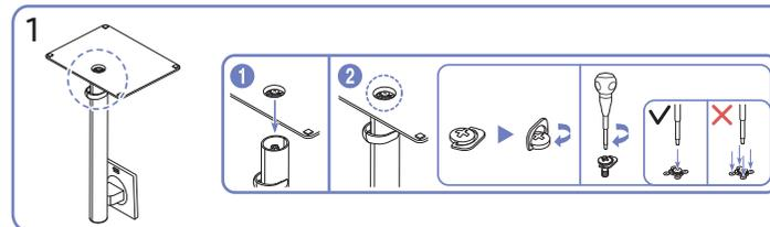
Coloque la base del soporte sobre el cuello del soporte en la dirección que se muestra en la ilustración. Compruebe que el conector del soporte esté bien asegurado. Gire completamente el tornillo de conexión en la parte inferior del soporte para que quede firmemente sujeto. Fije el tornillo grande en el centro para el montaje.
