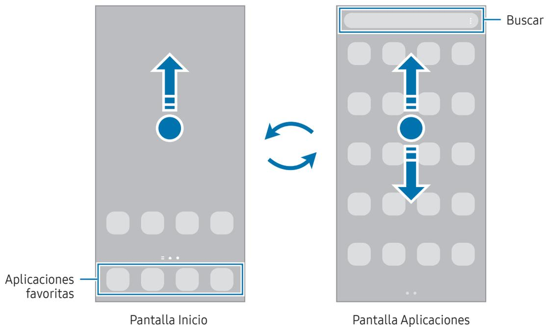
Si añade el botón Aplicaciones en la pantalla Inicio, podrá abrir la pantalla Aplicaciones pulsándolo. En la pantalla Inicio, mantenga pulsada un área vacía, pulse **Ajustes** y, a continuación, pulse el interruptor **Mostrar botón de pantalla Aplicaciones en pantalla Inicio** para activarlo. El botón Aplicaciones se añadirá en la parte inferior de la pantalla Inicio.
