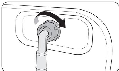
2. Conecte el otro extremo de la manguera de agua a la válvula de entrada situada en la parte posterior de la lavadora, y después gírela hacia la derecha para apretarla.
