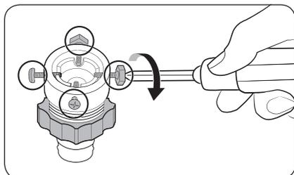
2. Utilice un destornillador Phillips para aflojar los cuatro tornillos del adaptador.
