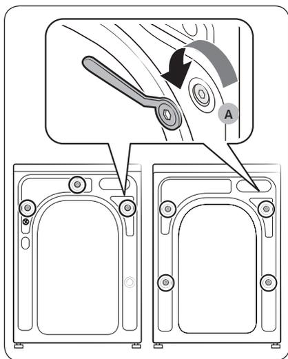
1. Coloque los **tornillos de transporte (A)** (marcados con un círculo en la imagen) en la parte posterior de la lavadora.
