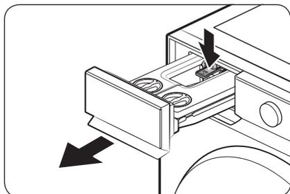
1. Sujetando la **palanca de desbloqueo** en su interior, tire de la cubeta para detergente para sacarlos.
