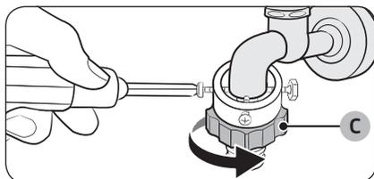
4. Inserte el adaptador en el grifo de agua y apriete los tornillos al tiempo que levanta el adaptador.
