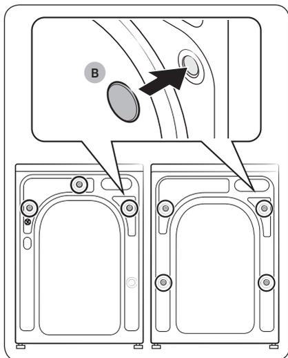
3. Inserte los **tapones de tornillos (B)** en los orificios.
