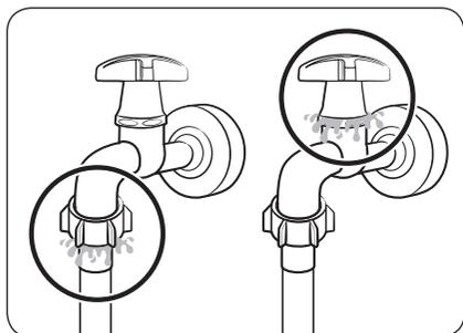
3. Abra el grifo del agua lentamente y asegúrese de que no hay fugas en las conexiones. Si hubiera fugas de agua, repita los pasos 1 y 2.
