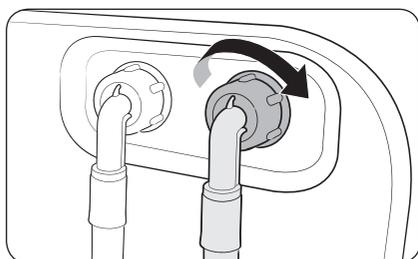
1. Conecte el extremo rojo de la manguera de agua caliente a la válvula de entrada de agua caliente situada en la parte posterior de la lavadora.
