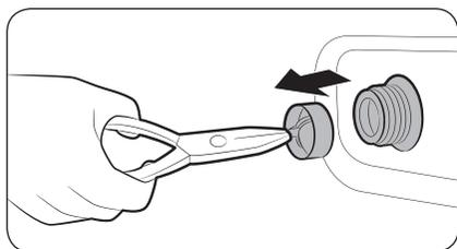
4. Utilice unos alicates para sacar el filtro de malla de la válvula de entrada.
