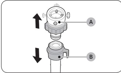
1. Retire el **adaptador (A)** de la **manguera (B)** de agua.
