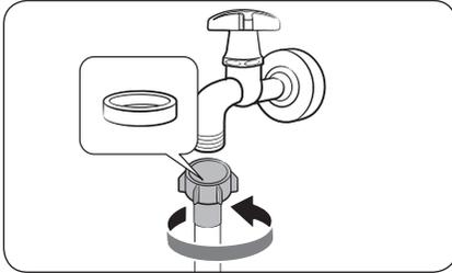
1. Conecte la manguera de agua al grifo y gire el conector en el sentido de las agujas del reloj como se muestra.
