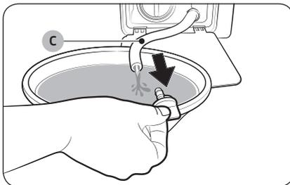
4. Abra el tapón del tubo y deje que el agua del **tubo de desagüe de emergencia (C)** se vacíe en el recipiente.
