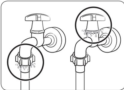
3. Abra el grifo del agua y asegúrese de que no hay fugas en las conexiones. Si hubiera fugas de agua, repita los pasos anteriores.
