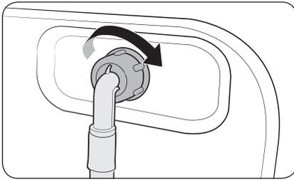
2. Conecte el otro extremo de la manguera de agua a la válvula de entrada situada en la parte posterior de la lavadora. Gire la manguera en el sentido de las agujas del reloj para apretarla.
