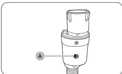
El Aqua Hose alerta a los usuarios del riesgo de fugas de agua. Detecta el flujo de agua y se ilumina en rojo en el centro del **indicador (A)** en caso de fuga.
