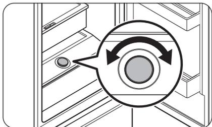
Humedad Fresca+ permite ajustar la humedad. Gire el dial de control a la izquierda o a la derecha para ajustar la humedad como desee.
