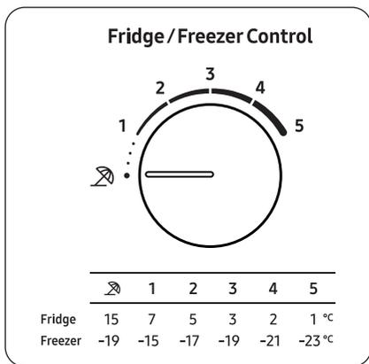
Para activar el modo Vacaciones, gire el dial de control del frigorífico/congelador a la posición . La temperatura del frigorífico permanecerá controlada por debajo de 15 °C y el congelador permanecerá controlado por debajo de -19 °C.
