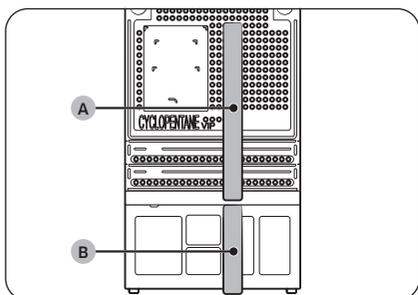
3. Coloque el espaciador (A, esponja) y el espaciador (B, esponja) proporcionados como se muestra en la figura para obtener una eficiencia energética óptima.
