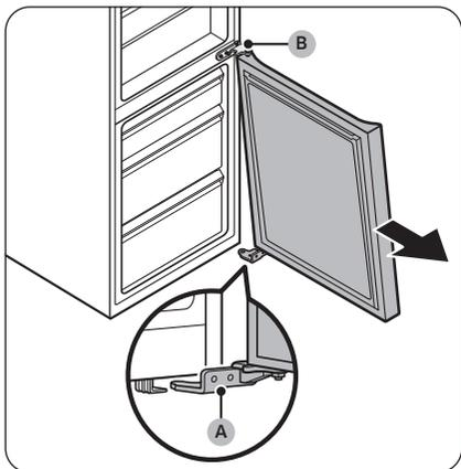
8. Con la puerta del congelador apoyada sobre la **bisagra inferior (A)**, tire lentamente de la **bisagra inferior (A)** para retirarla del soporte inferior del frigorífico. Una vez quitada la **bisagra inferior (A)** del soporte, retírela de la puerta del congelador, y después empuje la puerta del congelador hacia abajo para retirarla de la **bisagra central (B)**.
