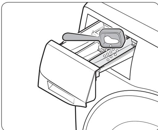
4. Si desea realizar un prelavado, ponga detergente para prelavado en el **1 compartimento del prelavado** siguiendo las instrucciones o recomendaciones del fabricante.
