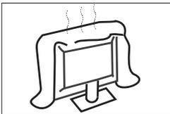
No bloquee los orificios de ventilación de la tapa trasera. Una ventilación adecuada es esencial para evitar fallos en los componentes eléctricos.
