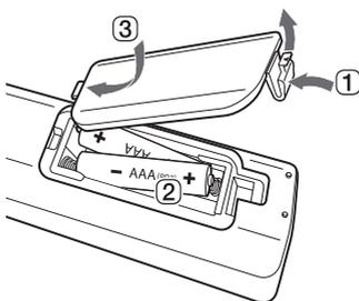
Use pilas AAA de 1,5 V. Para cambiar las dos pilas, introdúzcalas en el mando a distancia siguiendo las direcciones indicadas.
