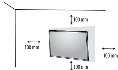
Si instala el monitor en una pared, fije un soporte de montaje en pared (opcional) en la parte trasera del monitor. Asegúrese de que el soporte de montaje en pared esté bien fijado al monitor y a la pared.
