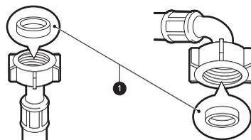
**Conexión del tubo al grifo de agua**
