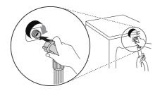
· No conecte el tubo al suministro de agua caliente para los modelos con una entrada de agua. Conecte solo al suministro de agua fría.
