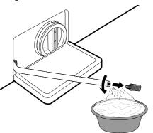
Desenrosque lentamente el filtro de la bomba de desagüe para drenar el agua remanente y luego proceda a retirar cualesquiera restos u objetos del filtro.
