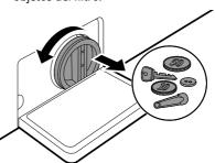
Después de limpiar el filtro de la bomba de desagüe, reinserte con cuidado el filtro y enrosque la tapa girándola hacia la derecha con cuidado para evitar apretarla en exceso y se produzcan fugas. Reinserte el tapón en el tubo de desagüe y coloque el tubo en su soporte.
