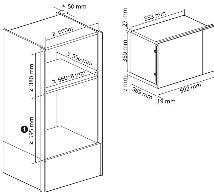
① Si se instala con un horno individual empotrable LG de 24"
