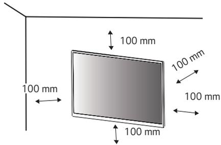
Si instala el monitor en una pared, fije un soporte de montaje en pared (opcional) en la parte trasera del monitor.
