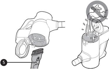
**7** Gire el cuerpo del producto y levante la palanca del Kompresor **6** para limpiar el interior de la placa de trabajo con el cepillo de limpieza, etc.
