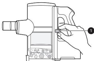
**3** Pulse el botón de liberación de la tapa del depósito de polvo **2** para abrir la tapa del depósito de polvo. Agite el depósito de polvo para vaciarlo.
