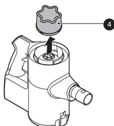
**7** Alinee la posición de bloqueo **6** de la tapa del filtro HEPA con la letra "H" **7** del botón **PUSH** del filtro HEPA.
