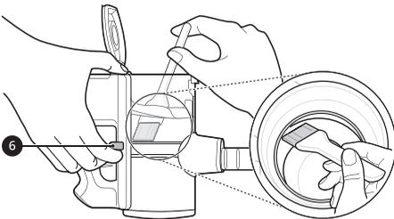
**8** Vuelva a dar la vuelta al cuerpo del producto y agítelo mientras presiona la palanca hacia abajo para eliminar el polvo.
