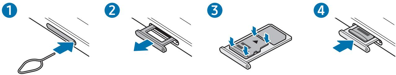
1 Para extraer la bandeja de la tarjeta SIM, inserte la anilla de extracción en el orificio de la bandeja.
