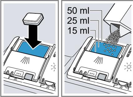
Si utiliza pastillas de detergente, basta una pastilla. Colocar las pastillas en posición transversal. Si emplea un detergente en polvo o líquido, tenga en cuenta las indicaciones de dosificación del fabricante y la graduación de dosificación de la cámara del detergente. Para vajilla con un grado de suciedad normal bastan 20–25 ml de detergente. Si la vajilla solo está ligeramente sucia, se puede emplear una cantidad algo más reducida de detergente.
