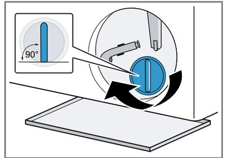
El asa de la tapa de la bomba debe estar en posición vertical.
