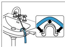
Fijar y asegurar la manguera de desagüe con un racor en codo. → "Accesorios", Página 30
