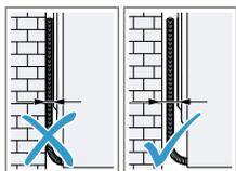
No aprisionar las mangueras ni el cable de conexión a la red entre la pared y el aparato.
