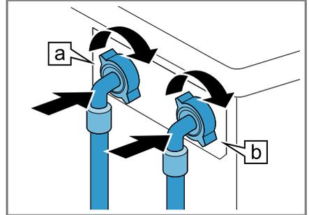
2. Conectar la manguera de alimentación de agua para agua caliente **[a]** (rojo) y agua fría **[b]** (azul) al grifo de agua (26,4 mm = 3/4").
