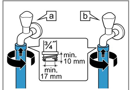
Si no hay disponible un grifo de agua para el agua caliente, empalmar la manguera de alimentación de agua solamente con la conexión de agua fría. Cubrir la toma de agua caliente del aparato para protegerla de la suciedad.
