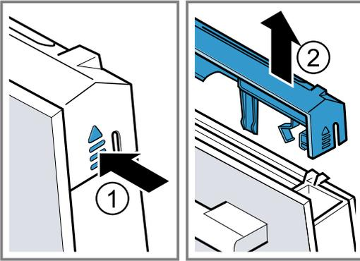
6. Extraer el cristal interior y depositarlo con cuidado sobre una superficie plana.
