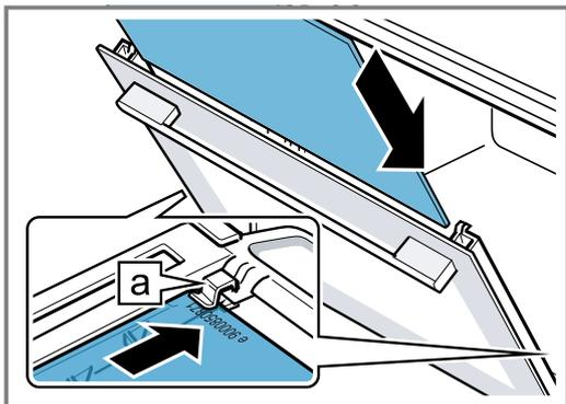
4. Presionar el cristal intermedio por arriba hasta que quede en la sujeción izquierda y derecha [a].
