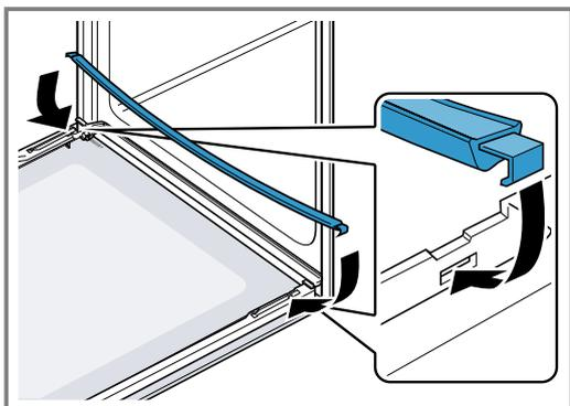
6. Desplazar el cristal interior en la sujeción izquierda y derecha [a].
