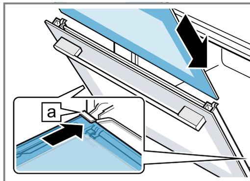
7. Presionar el cristal interior por arriba hasta que quede en la sujeción izquierda y derecha [a].
