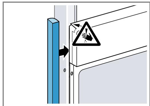
2. Fijar la pieza de relleno al mueble.
