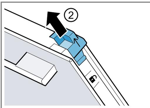
6. Extraer el cristal interior tirando de él hacia arriba en posición inclinada y depositarlo con cuidado sobre una superficie plana.
