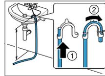
Deslizar la manguera de salida de agua completamente por el racor en codo y fijarla con el material de fijación. Fijar el racor en codo a una altura máxima de 100 cm.
