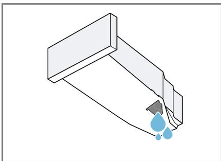
Comprobar regularmente el filtro del recipiente de agua condensada y limpiarlo si está sucio.
